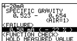
異常狀態（FAILURE）時的輸出值設定
